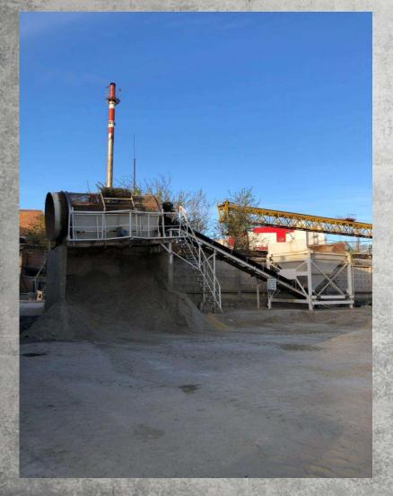
ОДНИМ ИЗ НЕСОМНЕННЫХ ДОСТОИНСТВ НАШЕГО ПРЕДПРИЯТИЯ ЯВЛЯЕТСЯ НАЛИЧИЕ АВТОМАТИЧЕСКОГО УЗЛА ОБОГАЩЕНИЯ ПЕСКА С ВОЗМОЖНОСТЬЮ УДАЛЕНИЯ КРУПНЫХ ВКЛЮЧЕНИЙ СВЫШЕ 20 ММ
